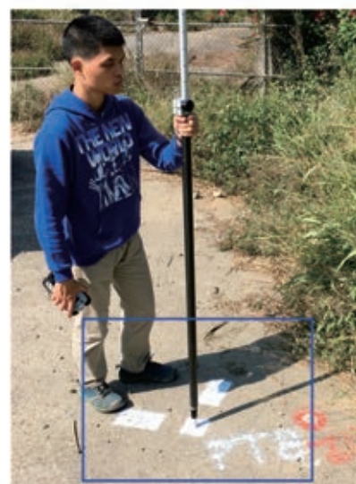
地面控制點測量情形與航空標種類示意圖，(a)板型框標，攜帶方便，適用於地形不易噴漆之區域；(b)L型噴漆框標，直接以噴漆或是油漆於地面做記號。
