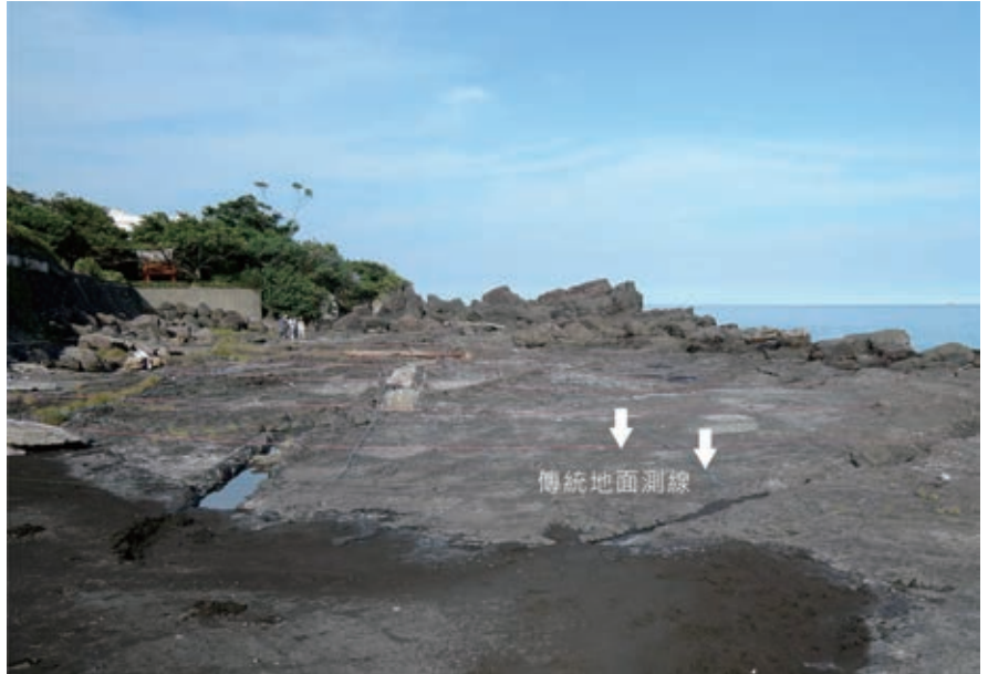
傳統地質測繪拉線法現場圖，在UAV不普及的年代，地質調查者常在需要記錄的露頭區域，設置固定大小的網格（如圖中紅藍線）進行細部調查記錄，測繪成果之精度較差，且過程耗時又費人力。現以UAV進行測繪，除了更快速且機動性高之外，對於地質構造分布的精度更能有效掌握。
